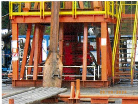
รูปที่ 2-30 ติดตั้งชุดอุปกรณ์ป้องกันการพลุ่ง (BOP) และ Shear Ram
